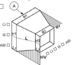
Beispiel für Höhenverschiebung (HV) und Breitenverschiebung (BV)
