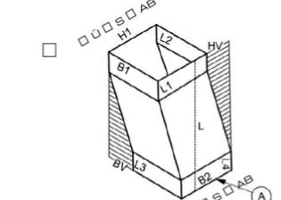
Beispiel für Höhenverschiebung (HV) und Breitenverschiebung (BV)
